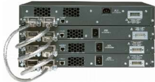
Pile de switchs 3750
